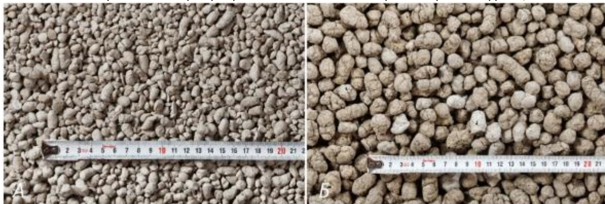
Рисунок 1.19 – Гранулированная пеностеклокерамика: А - фракция 5-10 мм, Б - фракция 10-20 мм
