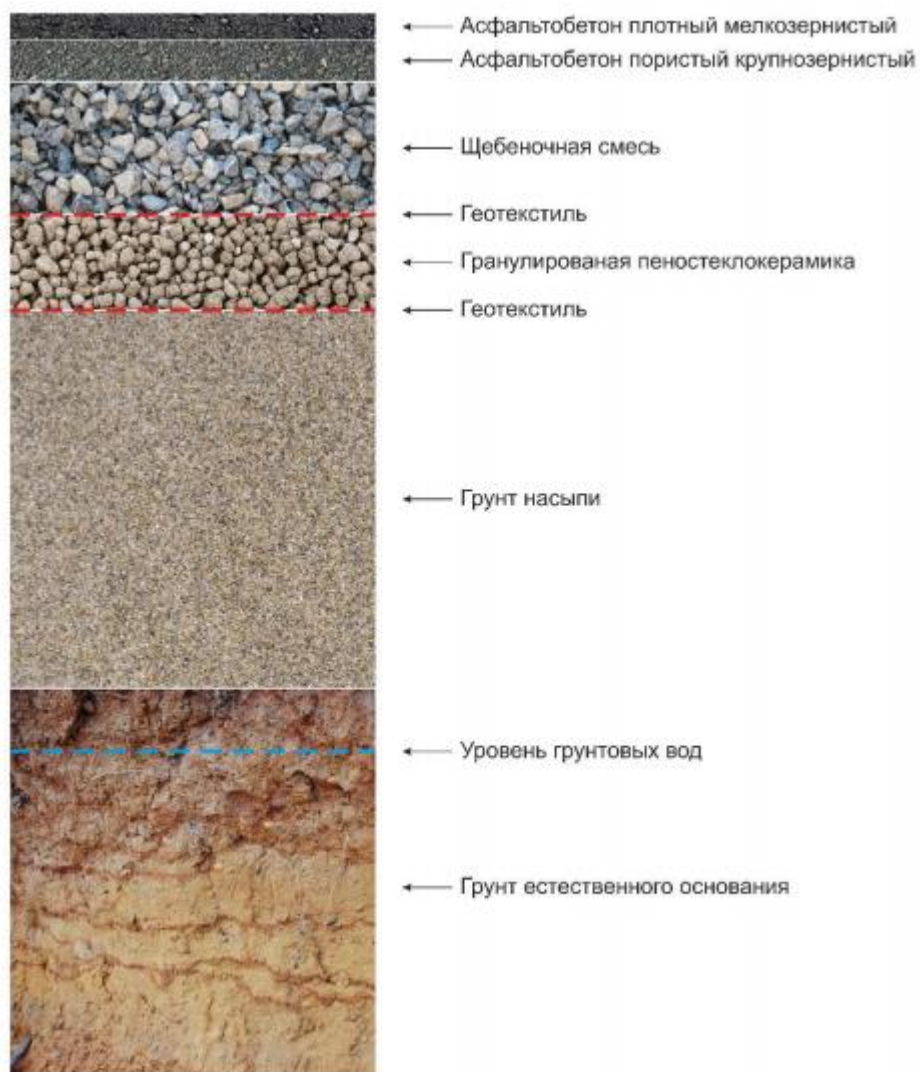
Рисунок 1.25 – Дорожная конструкция с дополнительным морозозащитным слоем из гранулированной пеностеклокерамики
